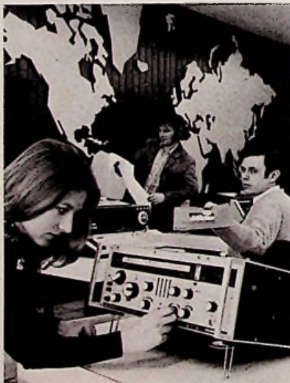
Voor draadloze communicatieverbindingen rondom de wereld is deze nieuwe, universeel bruikbare ontvanger E410 van Siemens geschikt. De ontvanger voldoet dan ook aan de veelzijdige eisen voor commercieel radioverkeer in het HF-bereik van 70 kHz tot 30 MHz en kan zowel stationair worden opgesteld of mobiel worden toegepast.
